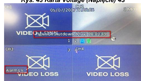
Rys. 44 Opóźnienie wyłączenia przy niskim napięciu 44
