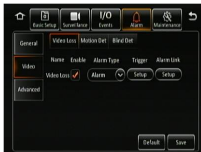
Rys. 86 Alarm zaniku sygnału 86
